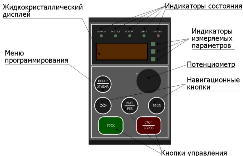
Рис. 6 Функции кнопок преобразования частоты.
