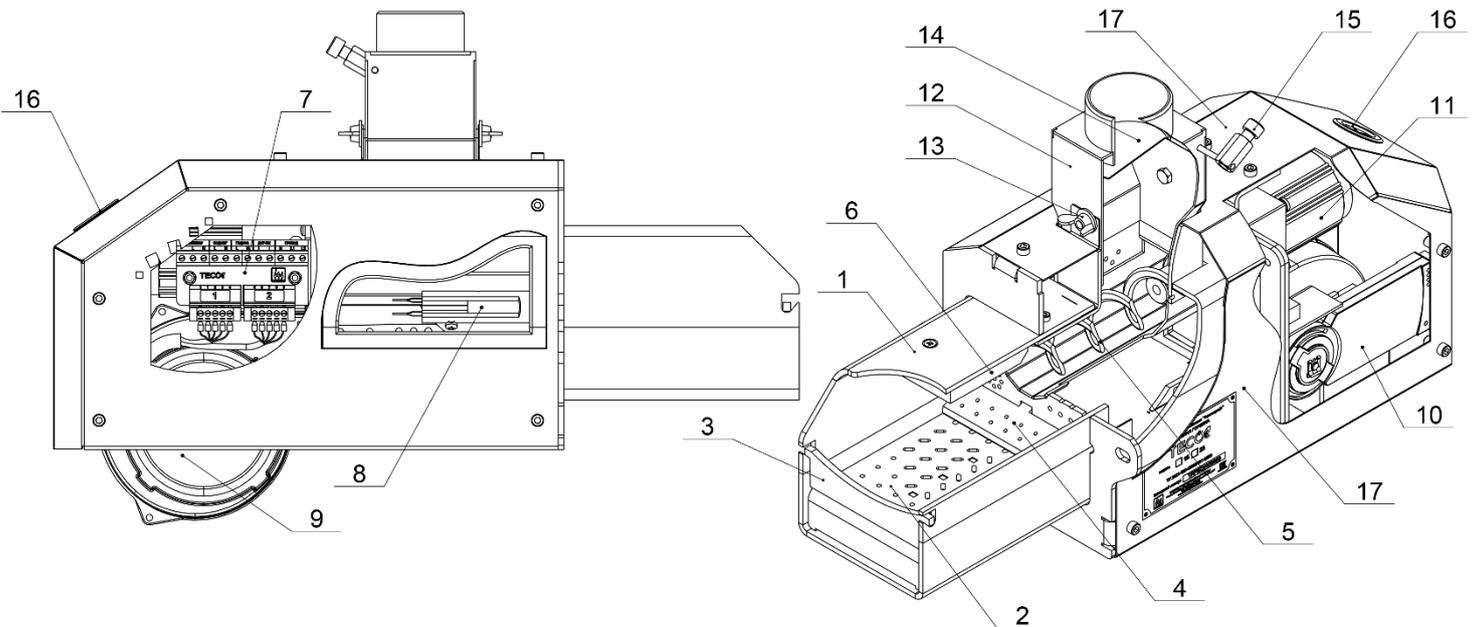
**Рис. 6 Устройство пеллетной горелки котла TECO PELLET**
