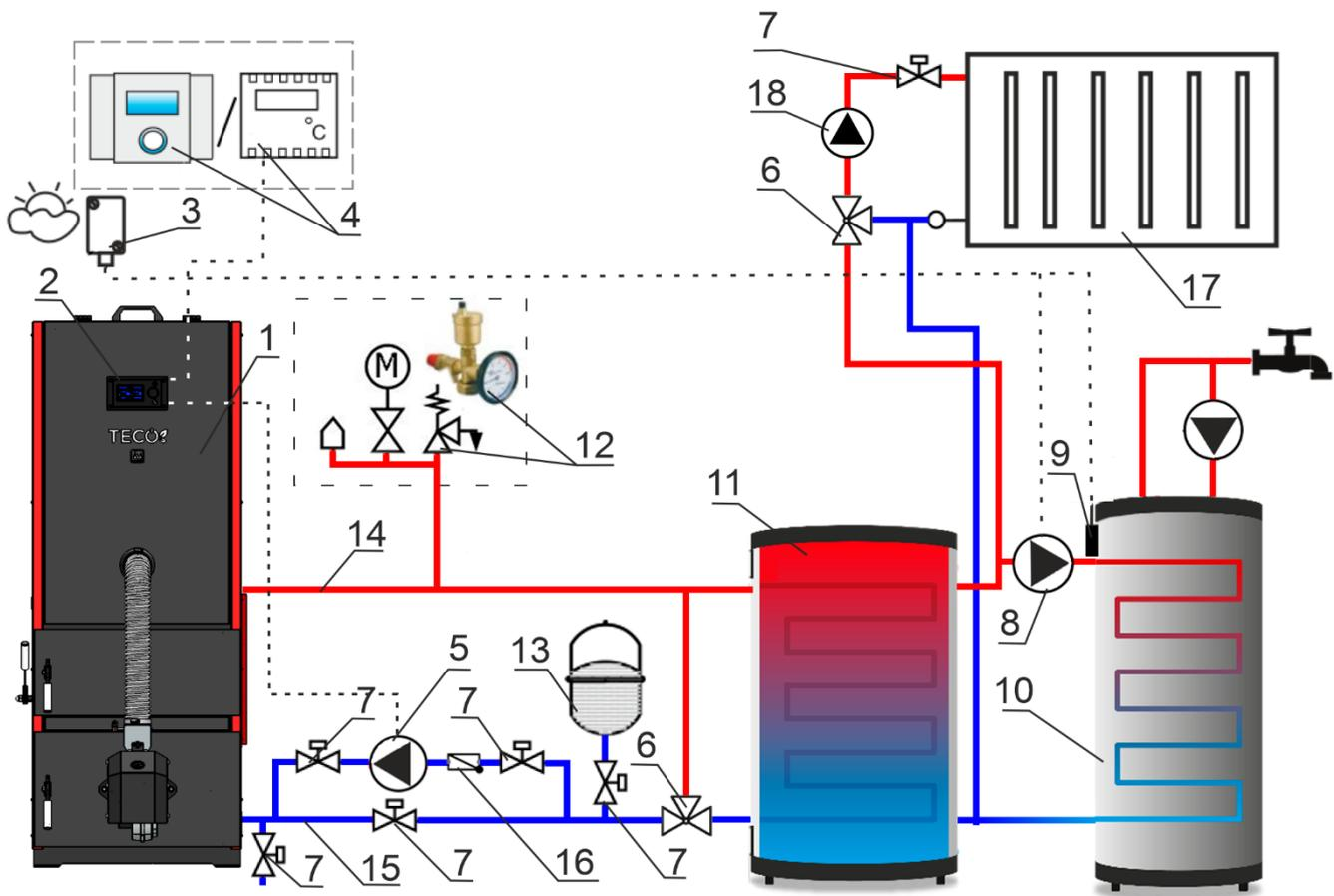
**Рис. 14 Гидравлическая схема подключения <sup>1</sup>**
