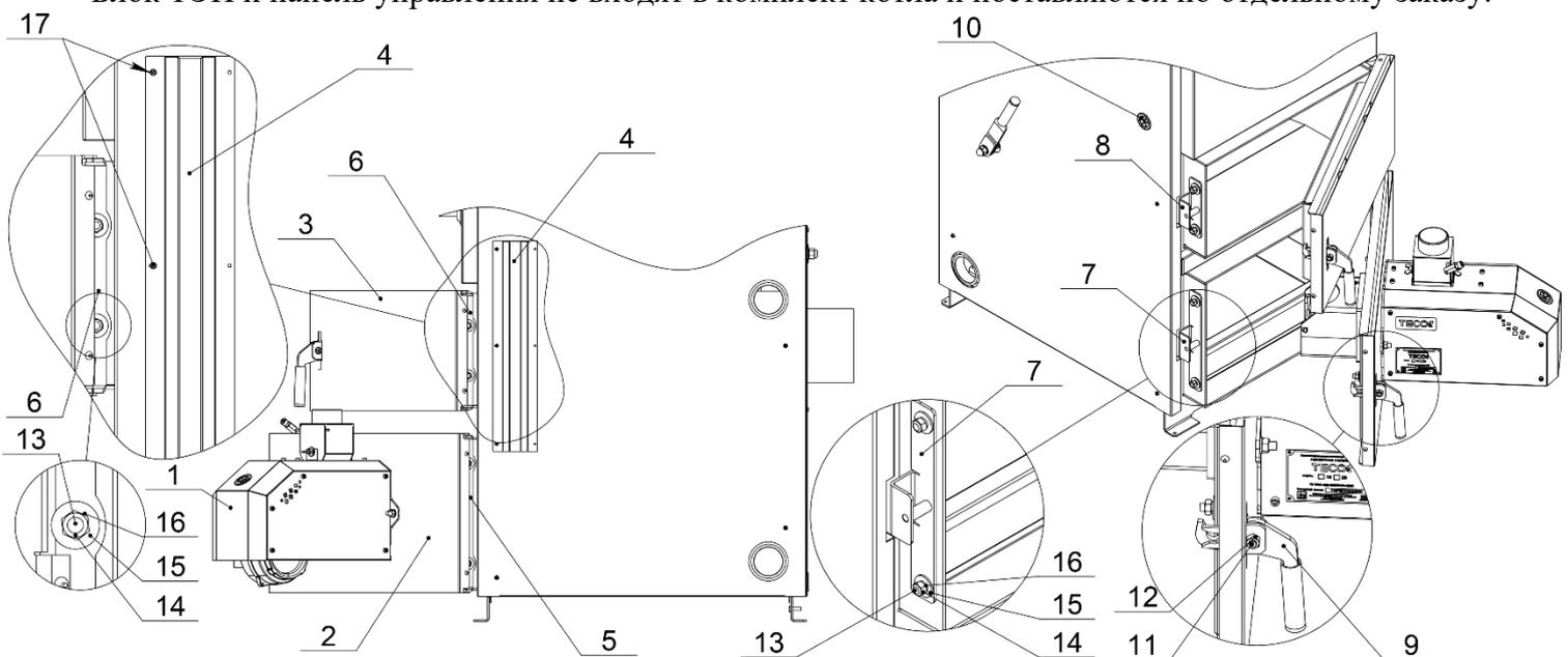
**Рис. 4 Изменение направления открытия дверей котла**
